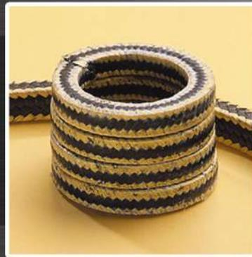
Empaquetadura multifibra: esquinas de fibras de aramida al 100% impregnadas con PTFE con nuestro procedimiento exclusivo “Filcoat” y las caras de fibras de PTFE grafitado y lubricado. La empaquetadura se trata durante el trenzado con una mezcla de PTFE y lubricante inerte.
